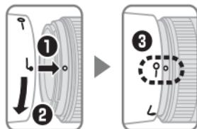
Rikta upp motljusskyddets låsmarkering (—○) med motljusskyddets monteringsmarkering (●) på objektivet (3).
