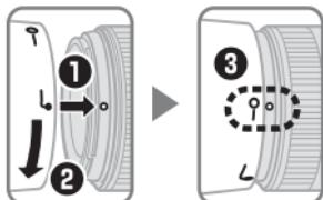
*Alinhe a marca de trava do para-sol da lente (—○) com a marca de fixação do para-sol da lente (●) na lente (3).*
