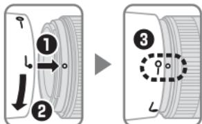
*Alinhe a marca de bloqueio do pára-sol da objectiva (—○) com a marca de montagem do pára-sol da objectiva (●) na objectiva (3).*
