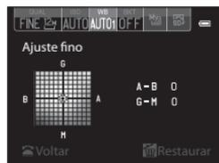
A cor exibida na tela de ajuste fino de balanço de brancos representa a cor aproximada na direção da temperatura de cor. Quando uma cor é definida na tela de ajuste fino, ela talvez não seja reproduzida exatamente na imagem. Por exemplo, quando o balanço de brancos for definido como **Incandescente**, a imagem não terá uma cor azul forte, mesmo que o ajuste fino seja executado na direção B (azul).
