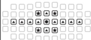
**Abertura máxima f/8** (p. ex., uma lente com abertura máxima de f/4, num teleconversor TC-20E III): a seleção do ponto de foco é suportada com 11 pontos: um sensor em cruz no centro do visor, 4 sensores em cada lado e 1 sensor de linha acima e abaixo. Os quatro pontos mostrados pelos símbolos ★ estão disponíveis apenas para AF com área dinâmica.
