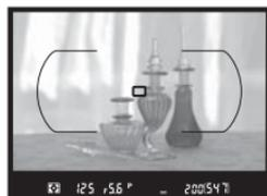
utilizando o multisselector e, em seguida, pressione o botão **AF-ON**. A câmara foca normalmente e define a exposição. *Tenha em atenção que NÃO é possível efectuar a focagem da câmara pressionando ligeiramente o botão de disparo do obturador.*
