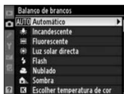
marque uma opção de balanço de brancos e prima ►. Se for seleccionada uma opção diferente de [Fluorescente], [Escolher temperatura de cor] ou [Predefinição manual], avance para o Passo 2. Se seleccionar [Fluorescente], marque um tipo de iluminação e prima ►. Se seleccionar [Escolher temperatura de cor], marque uma temperatura de cor e prima ►. Se seleccionar [Predefinição manual], escolha uma predefinição da forma descrita na página 144 antes de continuar.
