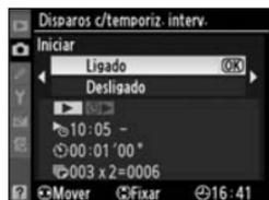
Será apresentada uma mensagem no monitor um minuto antes de ser efectuada cada série de disparos. Se não for possível continuar o disparo com as definições actuais (por exemplo, se a velocidade do obturador **b** ou **1/2** estiver seleccionada no modo de exposição manual ou se a hora de início for dentro de menos de um minuto), será apresentado um aviso no monitor.
