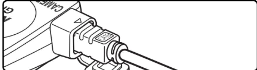
**3** Alignez le repère du connecteur au repère situé sur le boîtier de l'appareil photo, puis insérez le connecteur dans la prise de télécommande filaire à dix broches de l'appareil photo et resserrez l'écrou de blocage.
