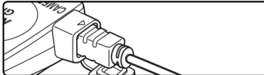
**3** Aprire il copricontatti accessorio della fotocamera e inserire GP1-CA90, come illustrato. Assicurarsi che il connettore sia posizionato secondo l'orientamento corretto; non esercitare una pressione eccessiva.
