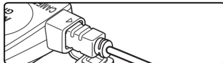
**3** Avaa kameran varusteliitännän suojuksen ja liitä GP1-CA90 kuvan osoittamalla tavalla. Varmista, että liitin on oikeassa asennossa; älä käytä voimaa.
