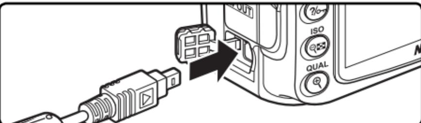
Подключение GP1-CA90 кабеля к D90 цифровой фотокамере
