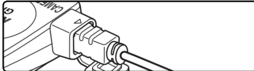
**3** Open het beschermkapje van de accessoireaansluiting van de camera en plaats de GP1-CA90 zoals wordt weergegeven. Zorg ervoor dat de connector in de juiste positie staat; oefen geen druk uit.
