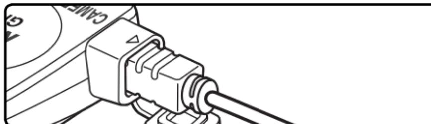
**3** Ouvrez le cache-contacts pour accessoires de l'appareil photo puis insérez le câble GP1-CA90 comme indiqué. Assurez-vous que le connecteur soit positionné correctement ; ne forcez pas.
