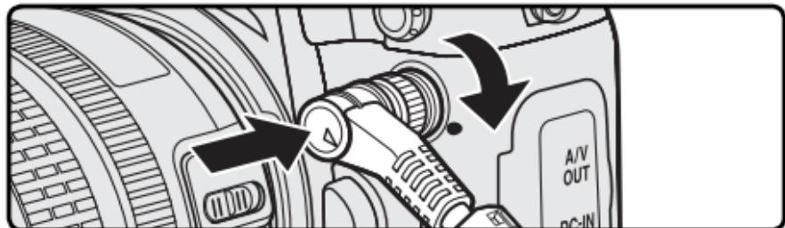
Conexión del GP-CA10 a una cámara digital D3
