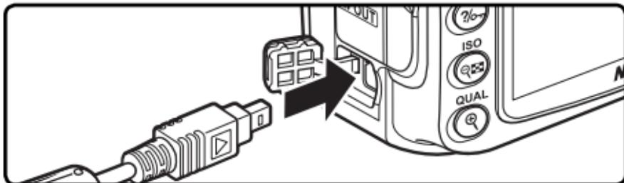
Conexión del GP1-CA90 a una cámara digital D90
