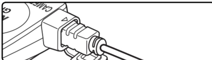
**3** Åpne kameraets tilbehørskontaktdeksel og sett inn GP1-CA90 som vist. Kontroller at kabelen er i riktig retning; ikke bruk makt.
