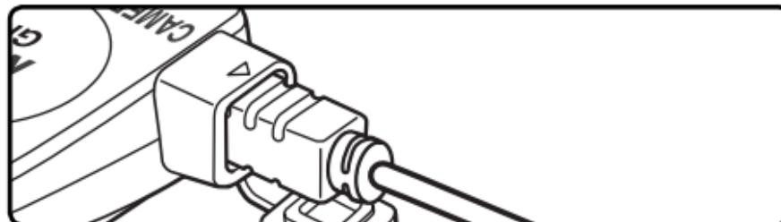
**3** Abrir a capa do terminal acessório da câmara e inserir o GP1-CA90 como na imagem. Certifique-se de que o conector está na posição correcta; não force.
