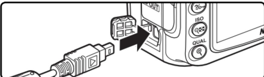
Podłączanie GP1-CA90 do cyfrowego aparatu D90
