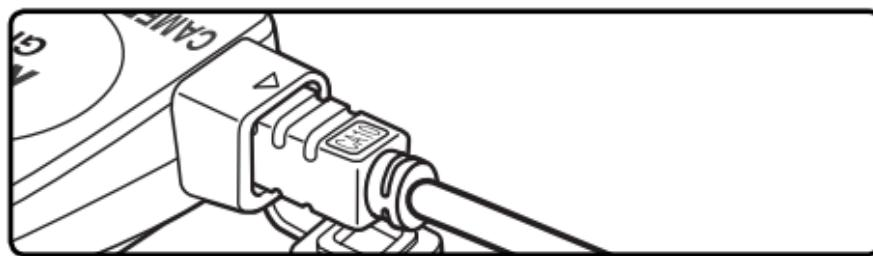
**3** Kohdistaliittimessä oleva merkkikameran rungossa olevaan merkkiin, työnnä 10-napainen liitin kameran 10-napaiseen kauko-ohjausliitintään ja kiristä lukitus.
