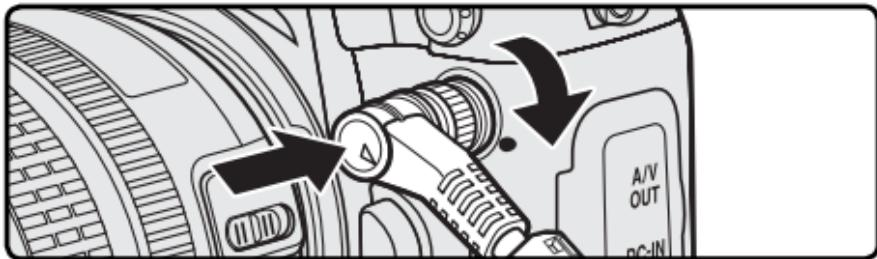
Tilslutning af GP1-CA10 til et D3 digitalkamera
