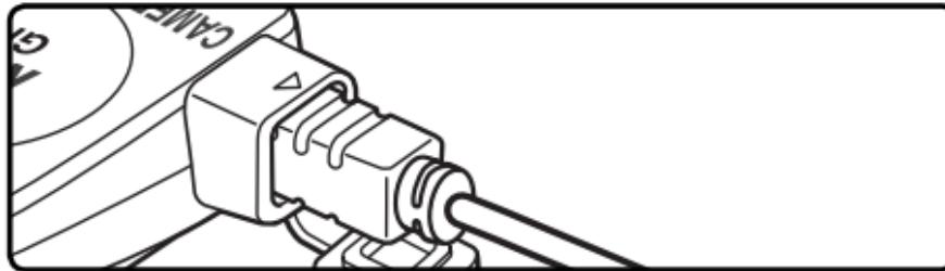
3 Abra la tapa del terminal para accesorios de la cámara e inserte el GP1-CA90 como se muestra. Asegúrese de que el conector se encuentre en la orientación correcta; no forzar.
