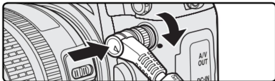
Подключение GP1-CA10 кабеля к D3 цифровой фотокамере
