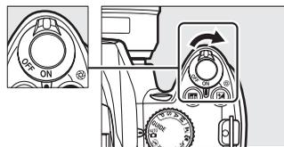
Faites pivoter le commutateur marche-arrêt comme indiqué pour mettre l'appareil photo hors tension.
