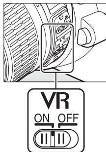
La réduction de vibration peut être éteinte en faisant coulisser le commutateur VR dans la position **OFF**. Éteignez la réduction de vibration lorsque l'appareil photo est monté en position fixe sur un pied mais laissez-la activée si la tête du pied n'est pas fixée ou lorsque vous utilisez un pied unique.
