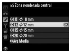
Tenga en cuenta que al menos que seleccione **Media**, el diámetro será fijado a 12 mm al utilizarse un objetivo sin CPU, sin importar el ajuste seleccionado para **Datos objetivos sin CPU** en el menú de configuración (☐ 212). Al seleccionar **Media**, se utilizará la media de la totalidad del fotograma en los objetivos con y sin CPU.
