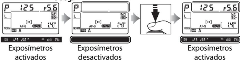
El momento de desconexión automática de los exposímetros puede ajustarse usando la configuración personalizada c2 (**Retardo apagado med. auto.**, □ 291).
