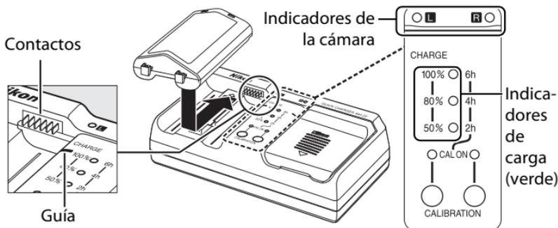
Inserte la batería (los terminales primero), alineando el extremo de la batería con la guía y después deslícela en la dirección indicada hasta que haga clic. El indicador de la cámara y los indicadores de carga parpadearán mientras carga la batería:
