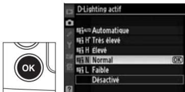
AUTO **Automatique** a été sélectionné, l'appareil photo ajuste automatiquement D-Lighting actif en fonction des conditions de prise de vue (en mode d'exposition **M**, cependant, AUTO **Automatique** est équivalent à N **Normal**).
