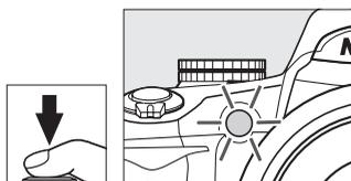
**Modos de retardado remoto o de respuesta rápida:** Desde una distancia de 5 m o menos, apunte con el transmisor del ML-L3 hacia el receptor de infrarrojos de la cámara y pulse el disparador en el ML-L3. En el modo de disparo retardado remoto, la luz del disparador automático se encenderá durante dos segundos antes de que se accione el disparador.
