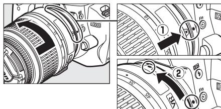
Deslice el dispositivo **A-M** a **A** (autofoco; si el objetivo tiene un dispositivo **M/A-M**, seleccione **M/A** para autofocus con prioridad manual).
