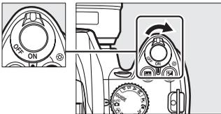
Gire el interruptor principal como se muestra en la figura para apagar la cámara.
