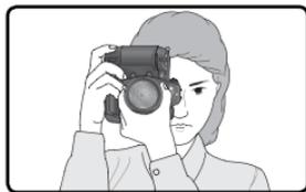
Le déclencheur secondaire (4) facilite la prise de vue en cadrage vertical.
