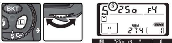
Pour déverrouiller la vitesse d'obturation, appuyez sur la commande
