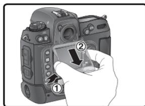
Pour remettre en place le protège-moniteur avant de photographier ou de ranger l'appareil, insérez les deux contacts situés en haut du protège-moniteur dans les encoches prévues à cet effet, situées au-dessus du moniteur (1). Appuyez ensuite sur la partie inférieure du protège-moniteur jusqu'à ce qu'il soit correctement fixé (2).
