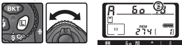
Pour déverrouiller l'ouverture, appuyez sur la commande
