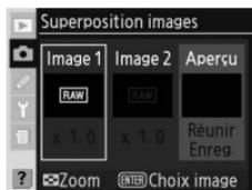
**3** Appuyez sur la commande **ENTER** pour afficher les images RAW de la carte mémoire. Appuyez à gauche ou à droite du sélecteur multidirectionnel pour mettre les images en surbrillance. Pour zoomer sur l'image sélectionnée, appuyez sur la commande **+** et maintenez-la enfoncée.
