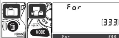
Mettez l'appareil photo sous tension et appuyez simultanément sur les commandes **FORMAT** (☒) et **MODE** pendant environ 2 secondes jusqu'à faire clignoter le symbole **For** sur l'écran de contrôle et dans le viseur.
