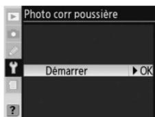
**1** Fixez un objectif à microprocesseur sur l'appareil photo (un objectif avec une focale d'au moins 50 mm est recommandé). L'option **Photo corr poussière** est disponible uniquement pour les objectifs avec microprocesseur. Si vous utilisez un zoom, zoomez en position de téléobjectif maximal.
