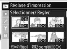
Appuyez sur la commande **OK** puis en haut ou en bas du sélecteur multidirectionnel pour préciser le nombre d'impressions (jusqu'à 99). Vous pouvez également appuyer au centre du sélecteur multidirectionnel pour sélectionner l'image et définir le nombre d'impressions sur 1. Les images sélectionnées sont signalées par l'icône
