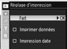
Revenez au menu Réglage d'impression. Pour sélectionner ou désélectionner une option, mettez-la en surbrillance et appuyez à droite du sélecteur multidirectionnel. Les rubriques sélectionnées sont marquées d'un
