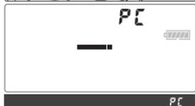
Si se está ejecutando Nikon Capture 4 Camera Control, el panel de control mostrará **PC** en lugar del número de exposiciones restantes. Cualquier fotografía que se tome se guardará en el disco duro del equipo informático en lugar de en la tarjeta de memoria de la cámara. Consulte el *Manual del usuario de Nikon Capture 4* para obtener más información.
