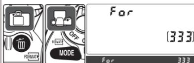
Encienda la cámara y pulse los botones **FORMAT** ( ) y **MODE** ( ) al mismo tiempo durante 2 segundos hasta que **For** parpadee en el panel de control y en el visor.
