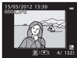
Cuando la imagen clave de una secuencia se muestra en el modo de reproducción a pantalla completa, pulse el botón **OK** para mostrar cada imagen de la secuencia individualmente. Para volver a mostrar solo la imagen clave, pulse **▲** en el multiselector.
