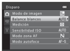
Pulse ▲ o ▼ en el multiselector giratorio para seleccionar un elemento y, a continuación, pulse los botones ▶ o OK. También puede seleccionar un elemento girando el multiselector giratorio.
