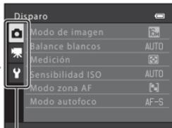
Pulse ▲ o ▼ en el multiselector giratorio para seleccionar una pestaña y, a continuación, pulse el botón OK o ▶.
