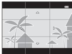
**6** Desplace la cámara lentamente y en línea recta en una de las cuatro direcciones y empiece a disparar.
