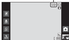
Estado de recepción GPS
