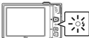
Si el nivel de batería es bajo, la pantalla se apagará y permanecerá apagada hasta que el flash se cargue completamente.
