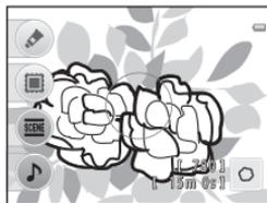
Cuando el zoom se encuentra en la posición del zoom de gran angular máxima, la cámara puede enfocar sujetos a una distancia de 5 cm (2 pulg.) de la parte frontal del cristal protector.
