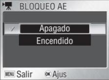
Seleccione **Encendido** para establecer la exposición y el balance de blancos de toda la película con los valores del primer fotograma, **Apagado** para medir los nuevos valores con cada toma. Cuando se selecciona **Encendido** en **AE lock**, el flash se apaga automáticamente. Presione el centro del multi-selector para realizar la selección y salir.
