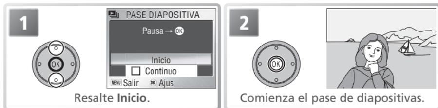
Para pasar a la imagen siguiente, presione el multi-selector hacia la derecha, o mantenga presionado el multi-selector para avanzar rápidamente en el pase. Para volver a la imagen anterior, presione el multi-selector hacia la izquierda o mantenga presionado el multi-selector para retroceder en el pase. Para poner en pausa el pase de diapositivas, presione en el centro del multi-selector. Aparecerá el menú que se muestra a continuación.
