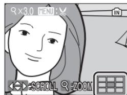
La guía que aparece en la esquina inferior derecha indica qué parte de la imagen se ha ampliado. Cambie la parte visualizada pulsando ▲, ▼, ◀ o ▶ en el multiselector.
