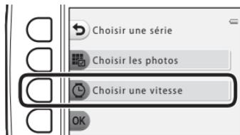
**4** Appuyez sur la commande polyvalente 2 (**Élevée**), la commande polyvalente 3 (**Normale**) (réglage par défaut) ou la commande polyvalente 4 (**Lente**) pour sélectionner la vitesse souhaitée.
