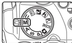
**2** Appuyez sur la commande ► du sélecteur multidirectionnel pour activer le réglage de la vitesse d'obturation.
