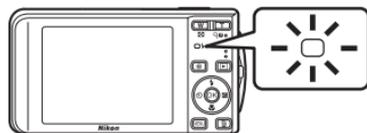
Si el nivel de batería es bajo después de disparar con el flash, la pantalla se apagará y el indicador de flash parpadeará hasta que el flash se haya cargado completamente.
