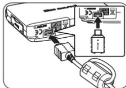
*Cuando conecte el adaptador, compruebe que el enchufe de CC tiene la orientación correcta. Introducir el enchufe al revés podría estropear la cámara o la COOL-STATION.*
