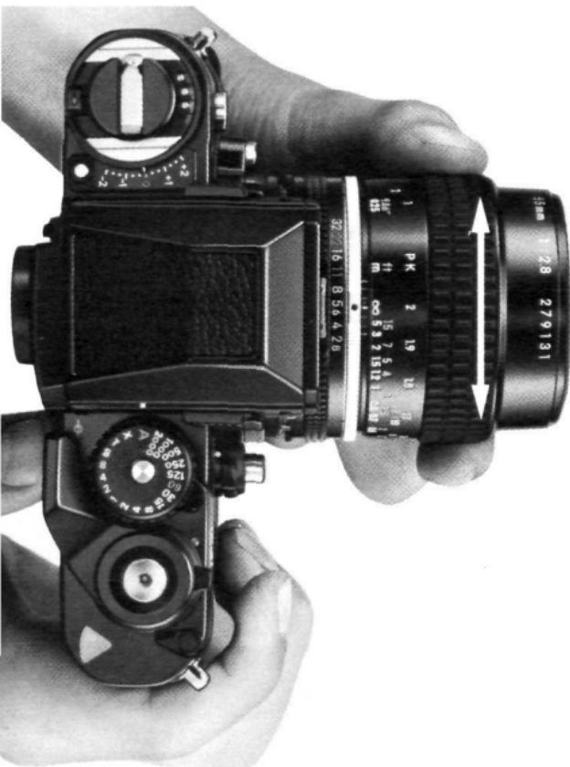
ピント合わせは、ファインダーを覗いて像が鮮明になるまで距離リングを回します。レンズ単体では無限遠から0.25m(倍率は1:2)まで、オート接写リングPK-13、あるいは $\infty$  テレコンバーターTC-201Sを併用するとさらに近接して等倍までの撮影ができます。これらを併用しても、レンズの自動絞り機構はそのまま使えますので、絞り開放でピント合わせができます。距離目盛は、メートル目盛(白色)とフィート目盛(黄色)が併記され、カメラのフィルム面から被写体までの距離を示します。
