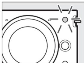
**Modo controle remoto:** aponte o ML-L3 para o receptor infravermelho na câmera (☞ 2) e pressione o botão de liberação do obturador do ML-L3 (posicione-o a uma distância de 5 m ou menos). No modo controle remoto com retardo, a luz do temporizador automático
