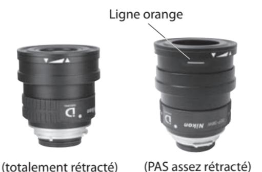
\*Lorsque vous placez un collimateur d'appareil photo numérique pour observer par digiscopie, assurez-vous que l'oculaire est entièrement rétracté, sinon l'oculaire ou l'appareil photo pourrait être endommagé en raison d'une mauvaise connexion ou pourrait être mal fixé et tomber, pouvant causer des dommages éventuels. Si la ligne orange est visible, cela signifie qu'il n'est PAS suffisamment rétracté.
