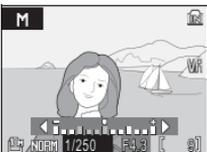
Réglez l'élément sélectionné. L'affichage de l'exposition indique de combien les photos seront sous-exposées ou surexposées aux réglages actuels (voir ci-dessous). Les vitesses d'obturation inférieures à  $1/4$  s sont affichées en rouge (☞ 40). La vitesse d'obturation  $1/2000$  s est disponible uniquement lorsque l'appareil photo est en position grand-angle maximal et que l'ouverture est réglée sur  $f/7.6$ .
