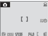
Le compte à rebours, affiché sur le moniteur, indique le nombre de secondes qu'il reste avant le déclenchement. Pour arrêter le retardateur avant que la photo ne soit prise, appuyez de nouveau sur le déclencheur.
