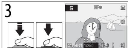
Prendre des photos. L'appareil compare immédiatement les distances des sujets en neuf zones de mise en point et règle la mise au point et l'exposition pour les sujets les plus proches (76).
