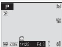
Appuyez sur le déclencheur jusqu'au bout pour démarrer l'enregistrement. L'appareil prend des photos à l'intervalle indiqué jusqu'à ce que vous appuyiez encore une fois sur le déclencheur, que la mémoire soit pleine, ou que 1800 vues puissent être enregistrées. Le moniteur est désactivé et le voyant d'alimentation clignote entre les prises de vue.
