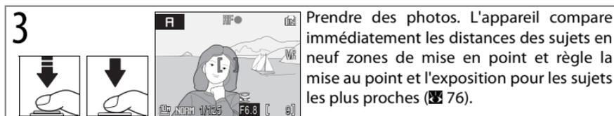
Si l'ouverture sélectionnée donne une photo surexposée ou sous-exposée, l'affichage de l'ouverture clignote lorsque vous appuyez sur le déclencheur à mi-course. Choisissez une autre ouverture, puis recommencez.
