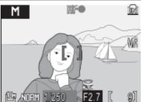
Prendre des photos. L'appareil compare immédiatement les distances des sujets en neuf zones de mise en point et règle la mise au point et l'exposition pour les sujets les plus proches (☞ 76).
