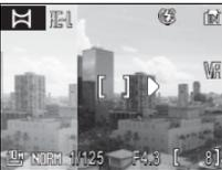
Prenez la première photo ; l'appareil photo effectue la mise au point sur le sujet au centre de la vue. Environ  $\frac{1}{3}$  de la photo est superposé sur la vue dans l'objectif. L'icône **AE-L** devient blanche pour indiquer que la balance des blancs et l'exposition de cette photo seront mémorisées pour toutes les photos de la série.
